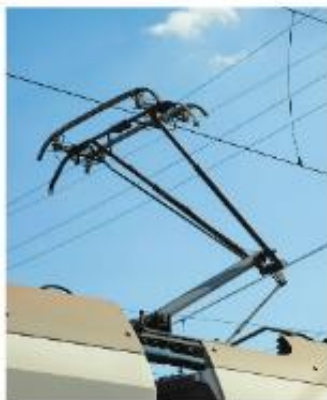
Pantograf – element łączący tramwaj z przewodami jezdnymi i odbierający prąd
